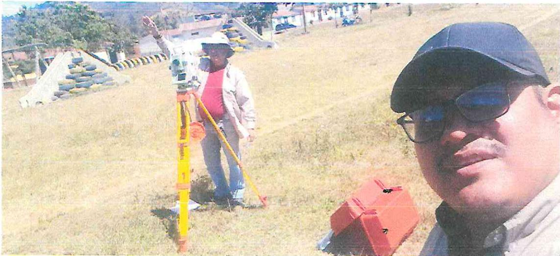
**Figura 2.** Medición de terreno ubicado en Aldea STAN, San Andrés Itzapa, Chimaltenango. Para determinar ubicación de lotes y área verde de dicha colonia
